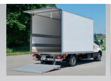
**Hebebühne** Tragkraft und Plattformhöhe nach Wahl
